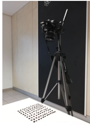
Figura 1.20: Macchina fotografica posizionata per scattare foto ai chicchi.
